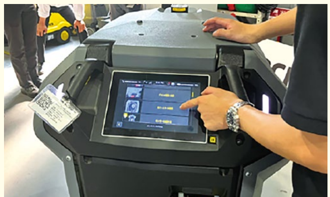
タッチ式のパネルで、メンテナンス方法をアニメーションで確認できる。
