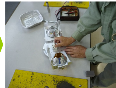
整備作業所点検 (灯器を分解し、部品の状態 点検・清掃等を実施)
