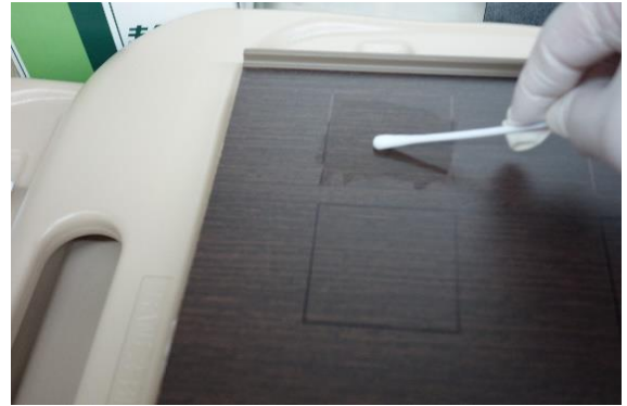
写真 J Test Field 表面のサンプリング
