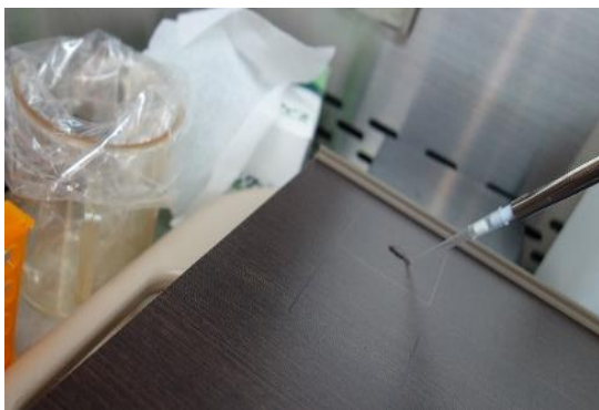
写真 C T1 フィールドに 50\mu\text{l} 滴下
