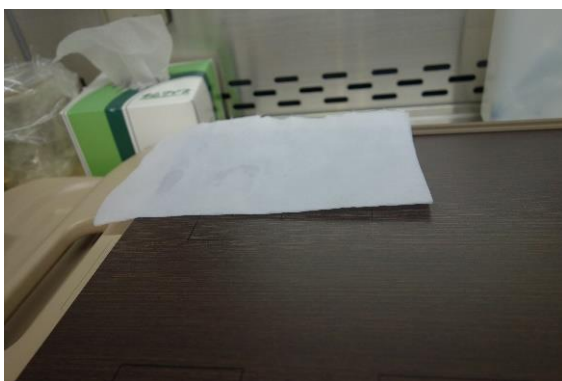
写真 G ワイプを試験面に置く
